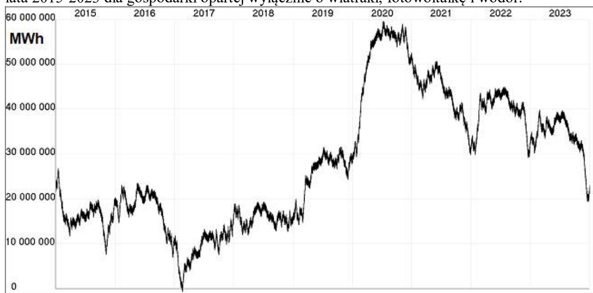
Rys.3.26. Wymagany przebieg stanu zapasów magazynowych wodoru w symulacji za lata 2015-2023 dla gospodarki opartej wyłącznie o wiatraki, fotowoltaikę i wodór.
